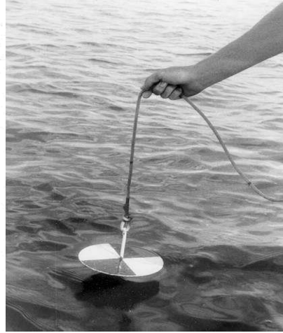
شكل (1-6): قياس عكارة الماء باستخدام قرص الشفافية (قرص سكي).
